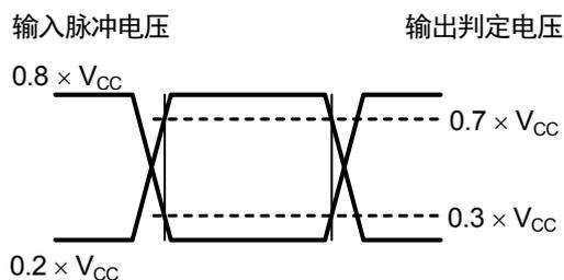
图1 AC测量输入、输出波形
