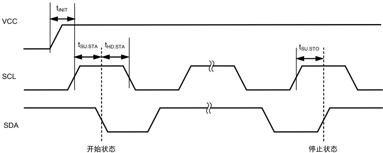
图5 电源接通后的开始 / 停止状态
