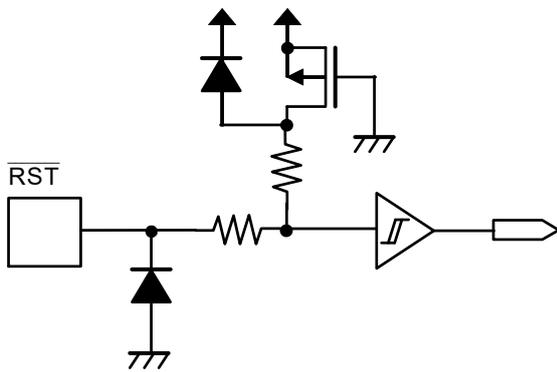
図5  $\overline{\text{RST}}$ 端子
