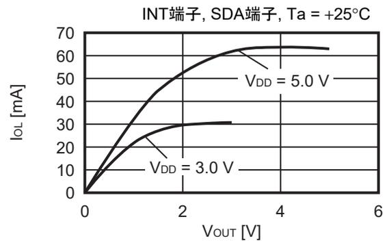
7. 高レベル出力電流 – V\_DD – V\_OUT特性
